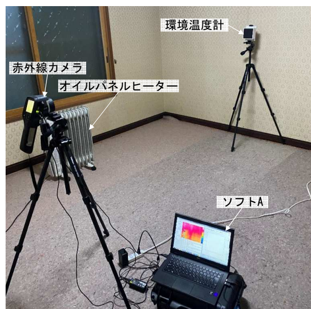
JJJ断熱診断の実施状況
